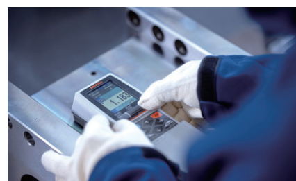
Тестер шероховатости измеряет шероховатость цилиндров экструдеров
