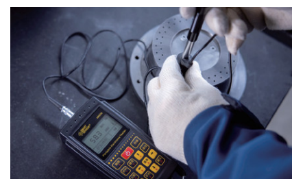
Твердомер Leeb измеряет твердость компонентов экструдера
