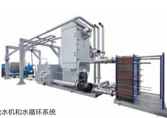
脱水机和水循环系统
