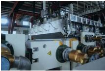
冷却辊特殊的冷却流道设计提高了整体辊面的温度一致性,硅胶包覆的辊面可以有效去除EVA胶膜的内部应力,从而显著的降低了成品收缩率。
